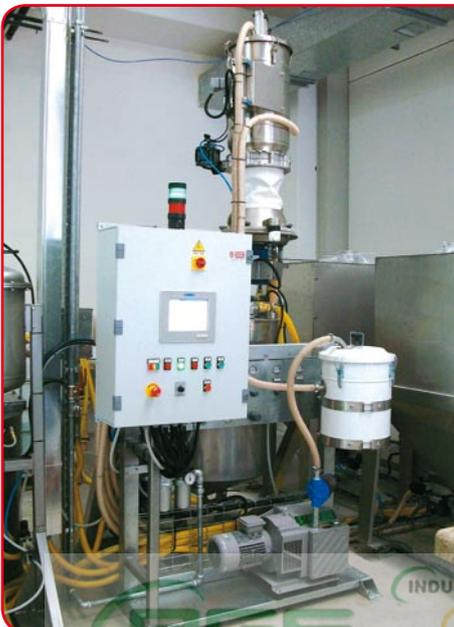
Sistema di trasporto e dosaggio con gestione di ricette per 4 additivi chimici, realizzato con pompa ad alto vuoto in un'industria del settore aeronautico.
