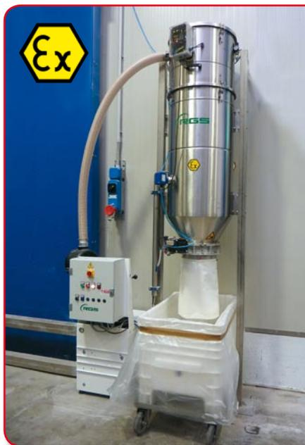
Sistema di trasporto pneumatico centralizzato per farine e residui di lavorazione in una pizzeria industriale. Sistema realizzato in versione ATEX per zona 22 polveri.
