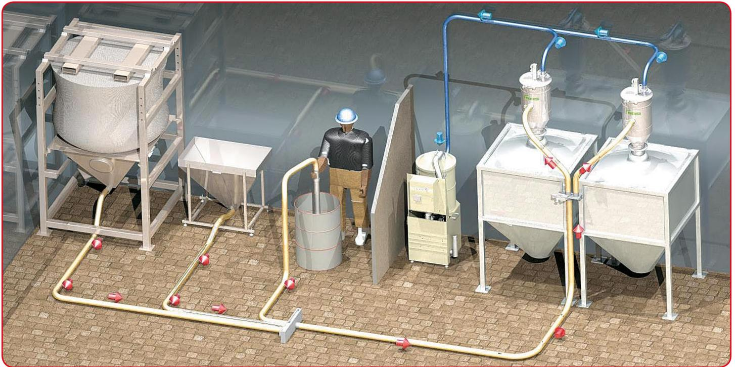
La pompa o unità aspirante crea una depressione all'interno della linea di trasporto (linea di tubazioni e filtro di arrivo materiale) in grado di generare un flusso d'aria che trasporta il prodotto.
