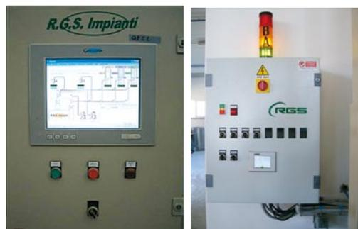
**Quadri elettrici** personalizzati interfacciati con sistemi di pesatura su celle di carico con sistemi PC o PLC per la gestione delle ricette.
