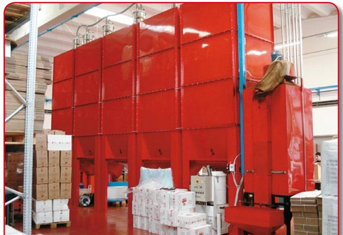
Sistema di caricamento e stoccaggio di 5 tipi di caffè tostato in una torrefazione industriale.
