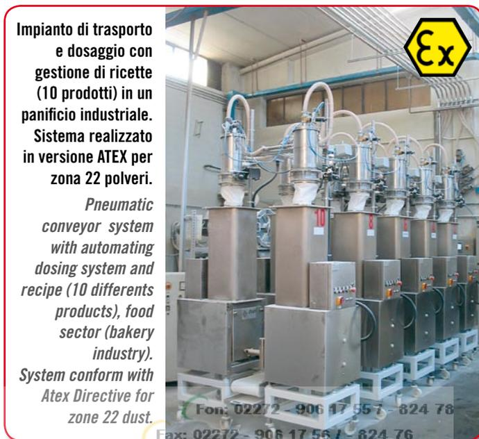
Impianto di trasporto e dosaggio con gestione di ricette (10 prodotti) in un panificio industriale. Sistema realizzato in versione ATEX per zona 22 polveri.
